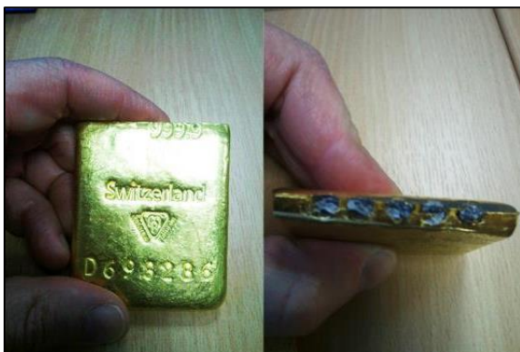
Рис. 9. Фальшивый килограммовый золотой слиток с вольфрамовыми стержнями внутри ( https://goldomania.ru/articles/fake_gold.html ).
