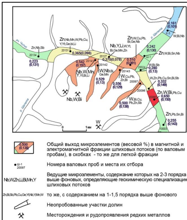
Рис. 5.8. Содержания микроэлементов в рыхлых образованиях участка Елиново по результатам спектрального анализа тяжелой и легкой фракций большеобъемных шлиховых проб
